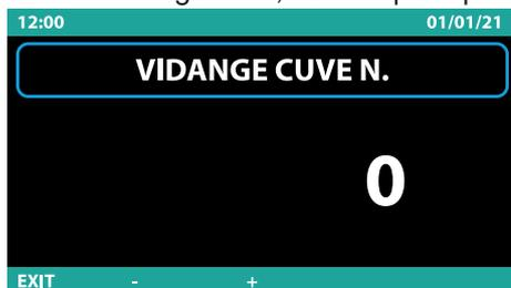
**N.B.:** Option, uniquement sur demande, pour arrêts des cycles de lavage entraînant la vidange/chargement automatique de la cuve.
