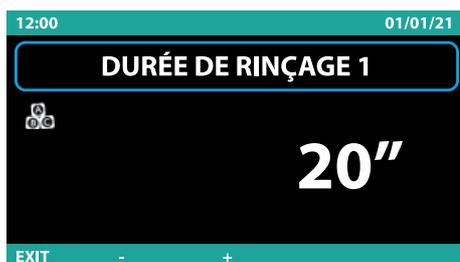
**Attention: un mauvais réglage de ces paramètres entraîne une faible qualité de rinçage et/ou le gaspillage d'eau et liquide de rinçage.**
