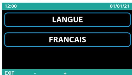
Avec les touches **C** (augmente) et **D** (diminue), sélectionner le paramètre **Langue**. Confirmer la sélection de chaque chiffre en appuyant sur la touche Start **A**.
